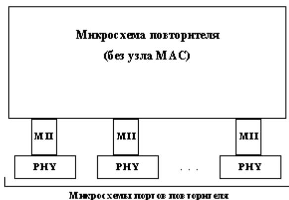
Рис. 22. Повторитель со встроенными устройствами РНУ
