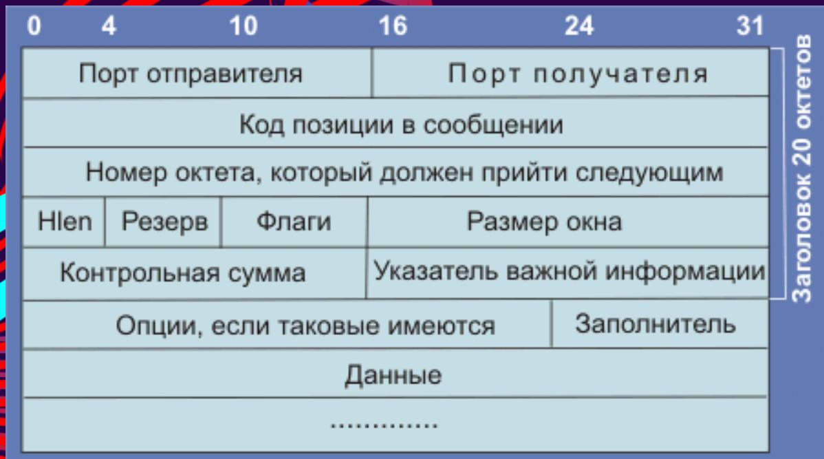
Поле **опции** зарезервировано на будущее и в заголовке может отсутствовать, его размер переменен и дополняется до кратного 32-бит с помощью поля **заполнитель**.
