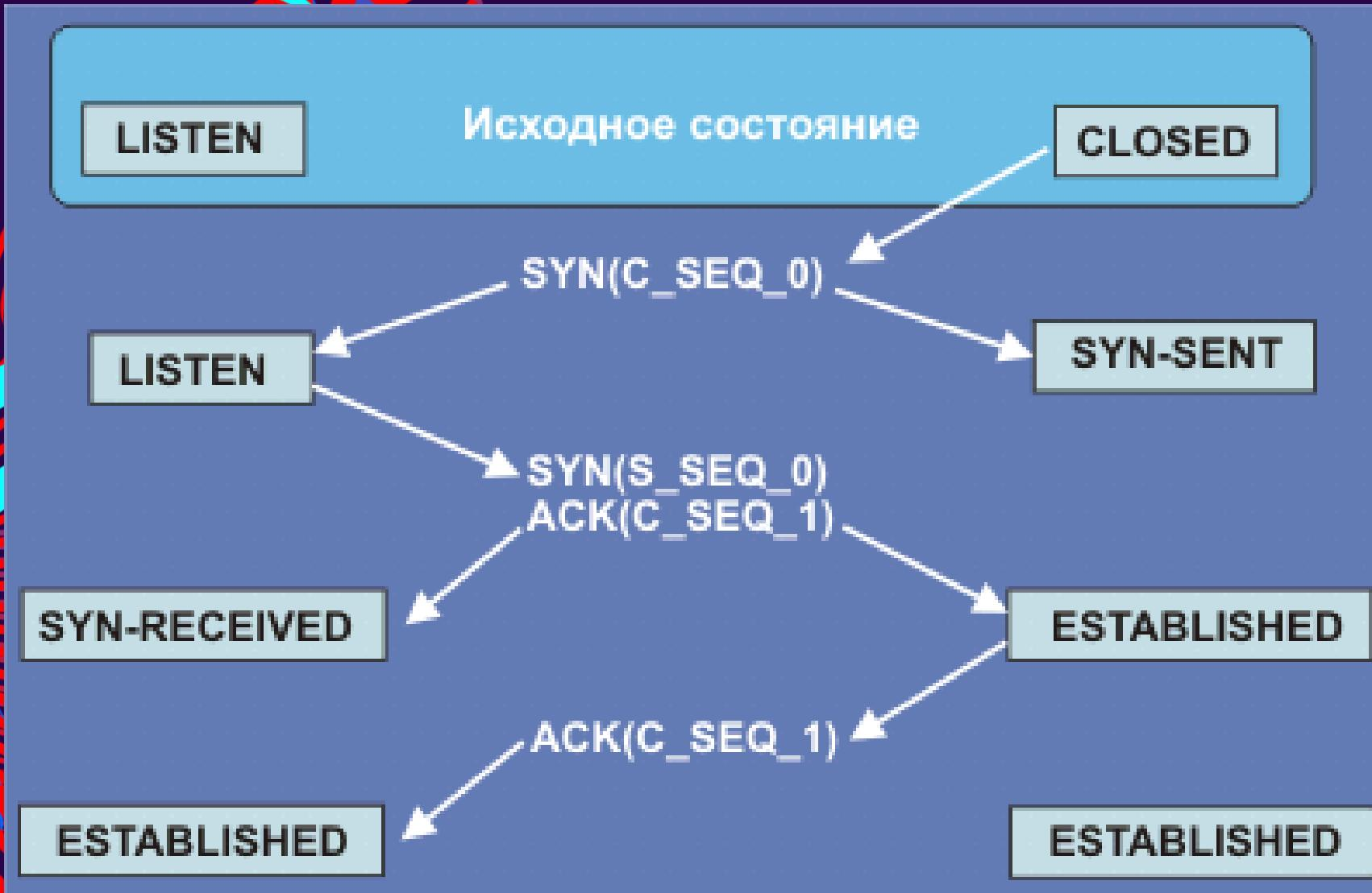
После установления соединения  $ISN(S) = s\_seq\_1$ , а  $ISN(C) = c\_seq\_1$
