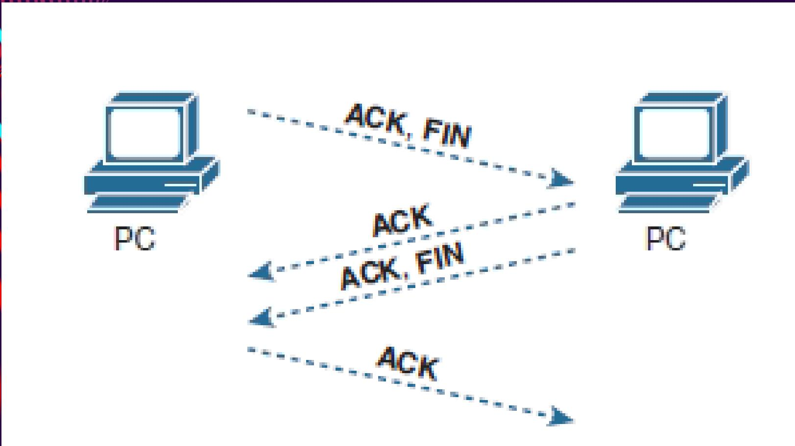
Четырехэтапная последовательность завершения. Используется 46 дополнительный флаг, называемый битом FIN.
